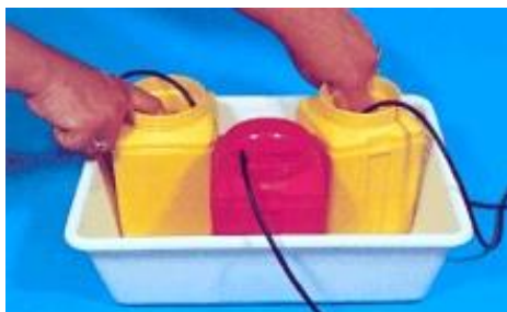
Figura 1 – Esperimento di Locke con le dita e con i sensori: si esplorano sensazione termica e temperatura nel passaggio dall'acqua calda/fredda a quella tiepida. Si vogliono distinguere le due informazioni.
